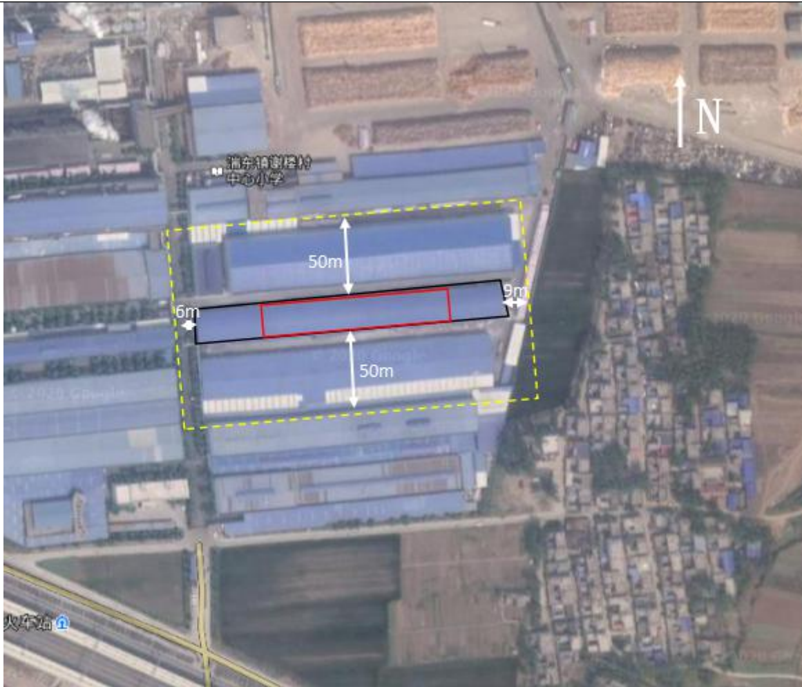
图6 项目卫生防护距离示意图（黄线虚线为卫生防护距离）
